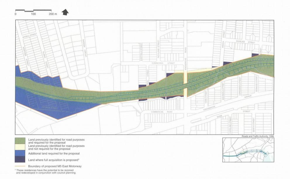
FIGURE 47— LAND REQUIRED FOR THE PROPOSED MOTORWAY
